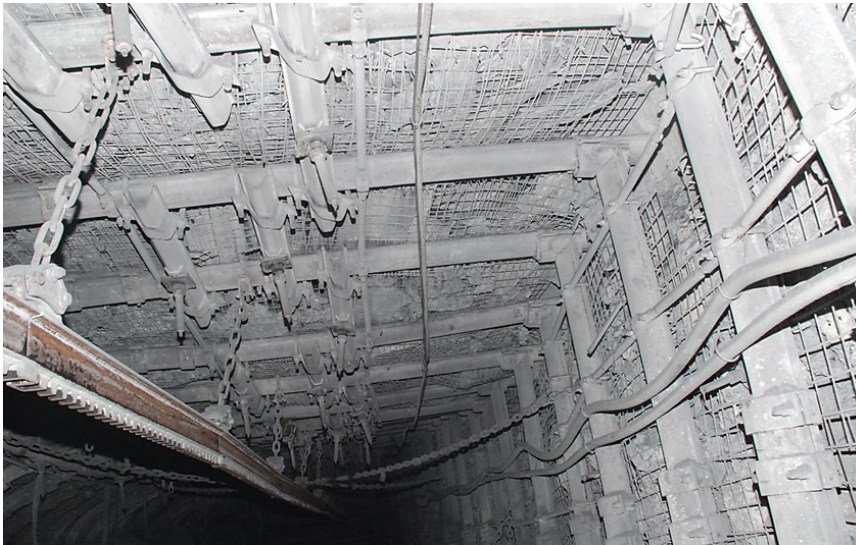
Rys. 9.4 Wzmocnienia obudowy chodników przyścianowych w rejonie ściany 29
