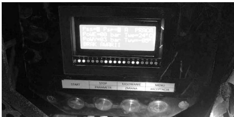
Rys. 47.1 Wyświetlacz z parametrami pracy chłodziarki
