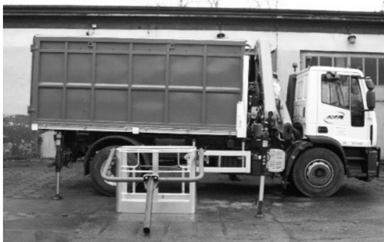
Rys. 12.1 Żuraw EFFER 175/5S z koszem roboczym. Kosz roboczy – przed podwoziem
