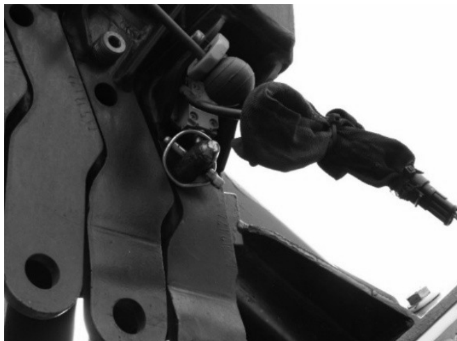
Rys. 12.8 Sposób połączenia przewodu elektrycznego kosza z ogranicznikiem obciążenia żurawia
