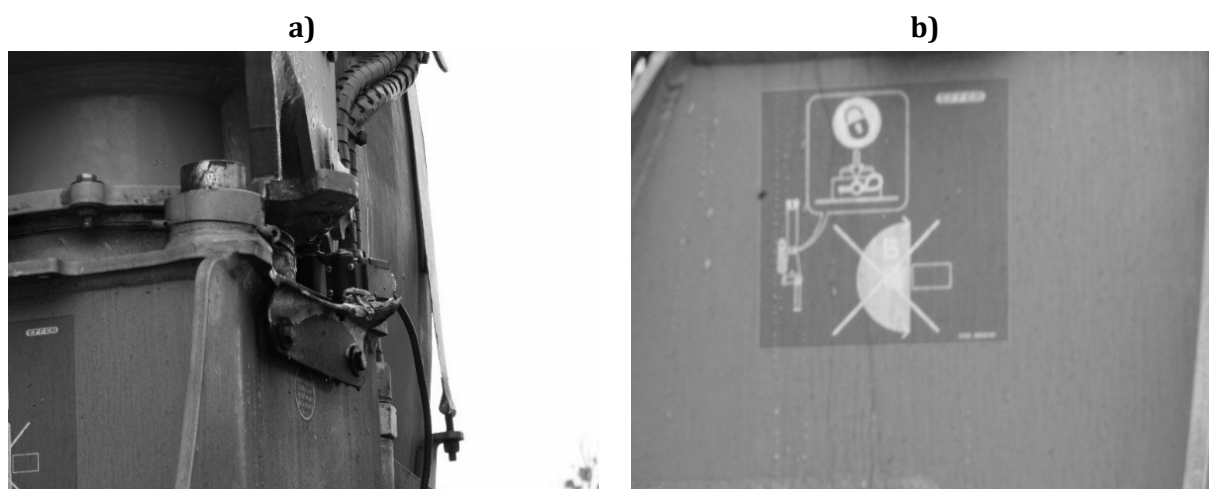
Rys. 12.3 Mechaniczna blokada kąta obrotu za pomocą sworznia zamontowanego w podstawie
