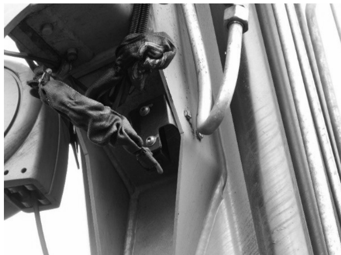
Rys. 12.5 Czujnik kąta na ramieniu zewnętrznym
