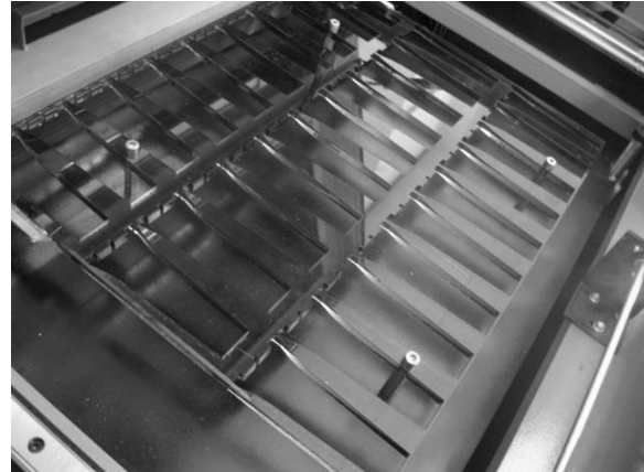
Rys. 8.5 Stara i nowa matryca do znakowania końcówek umieszczona na blacie plotera
