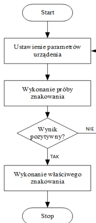
Rys. 8.6 Procedura dobierania parametrów plotera laserowego
