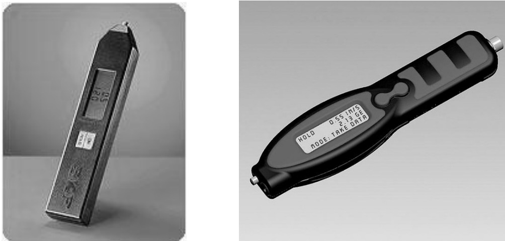
Rys. 4.6 Pióro wibrometryczne Pen plus CMVP 50 oraz tester stanu maszyny CMAS100 [8]
