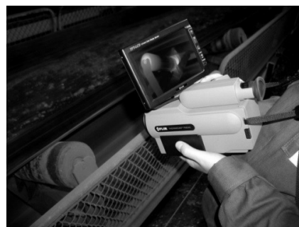
Rys. 4.2 Kamera termowizyjna FLIR i40, oraz Therma Cam PM 545 podczas pomiarów na taśmociągach [8]
