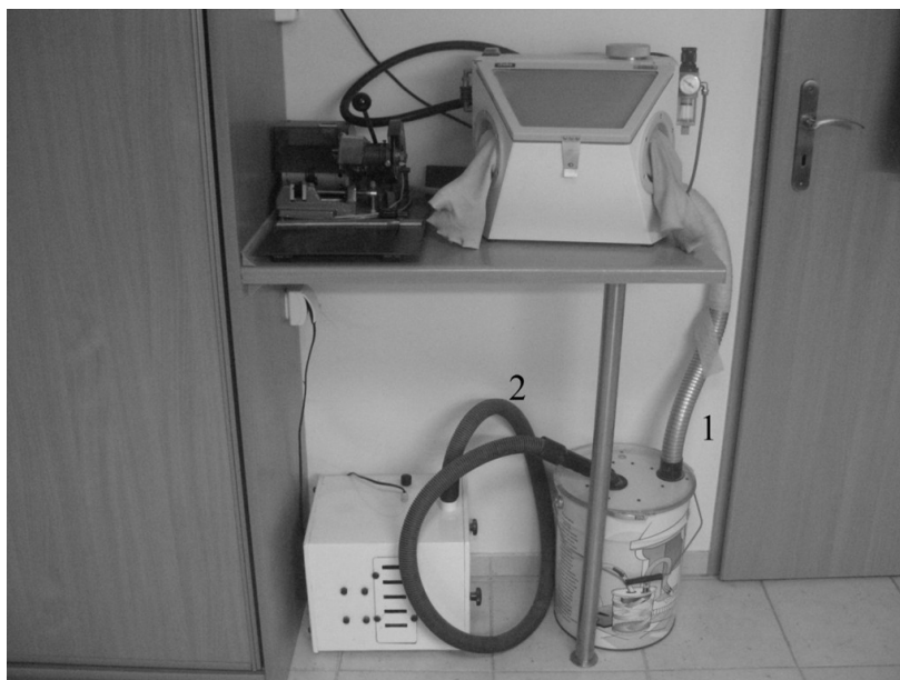
Rys. 9.4 Odciąg miejscowy wraz z separatorem podłączony do piaskarki
