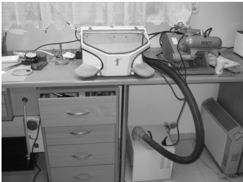
Rys. 9.5 Odciąg miejscowy podłączony do osłony
