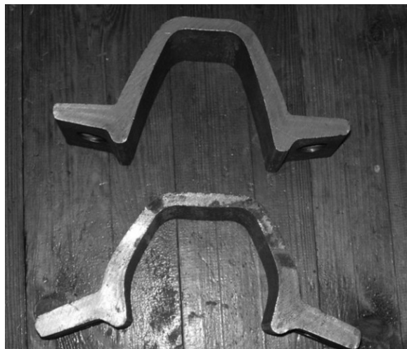
Rys. 6.15 Widoki jarzm dolnych strzemia SD029 przed i po badaniu
