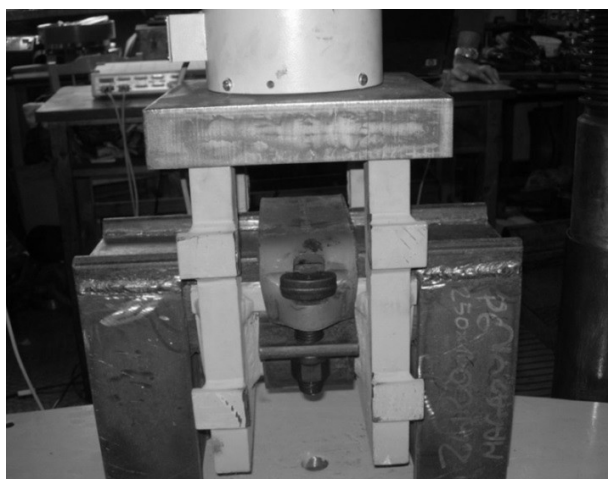
Rys. 6.7 Przyrząd do badania strzemion na rozciąganie z zamontowanym strzemieniem SDO29
