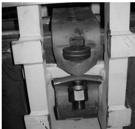
Rys. 6.9 Widok strzemięcia SDO29 po badaniu na rozciąganie
